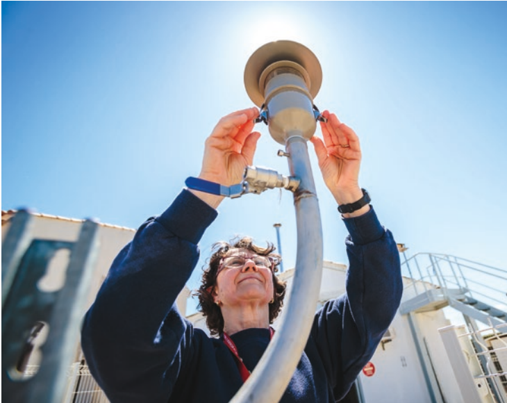
PRÈLEVEMENT D'UN FILTRE PAPIER PIÈGEANT LES AÉROSOLS DE L'AIR
